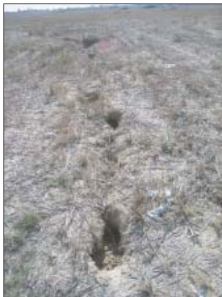
Εικ. 27. Φωτογραφία ενδεικτική του μήκους και του πλάτους (μέχρι και 60 εκατοστά) των ρωγμών στην περιοχή Τερσεφάνου. Fig. 27. Photograph indicative of the length and width (up to 60 cm) of the linear cracks in sediments in the Tersefanou area.
