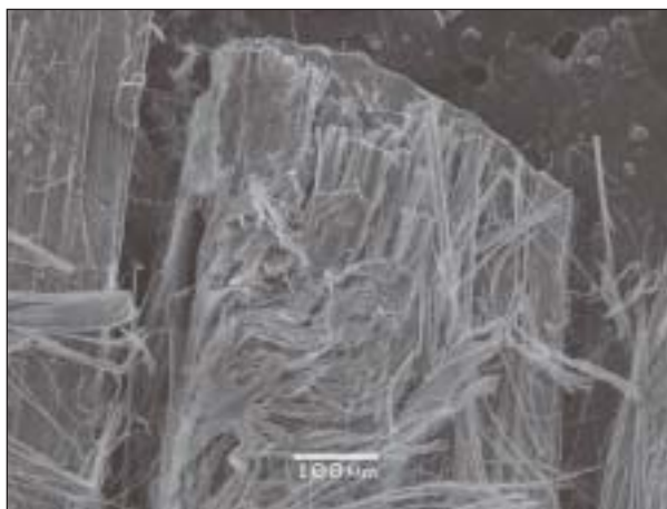
Εικ. 6. Φωτομικρογραφία ηλεκτρονικού μικροσκοπίου σάρωσης όπου φαίνονται ίνες χρυσωτιλικού αμιάντου. Fig. 6. Scanning Electron Microscope photomicrograph showing chrysotile asbestos fibres.
