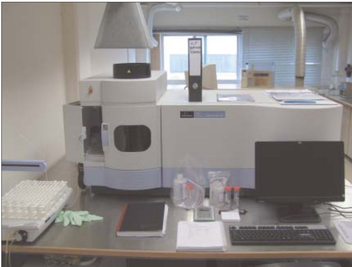
Εικ. 31. Το νέο φασματοσκόπιο επαγωγικά συζευγμένου πλάσματος ατομικής εκπομπής (ICP OES) για αναλύσεις ιχνοστοιχείων σε νερά, εδάφη, πετρώματα και δομικά υλικά.
