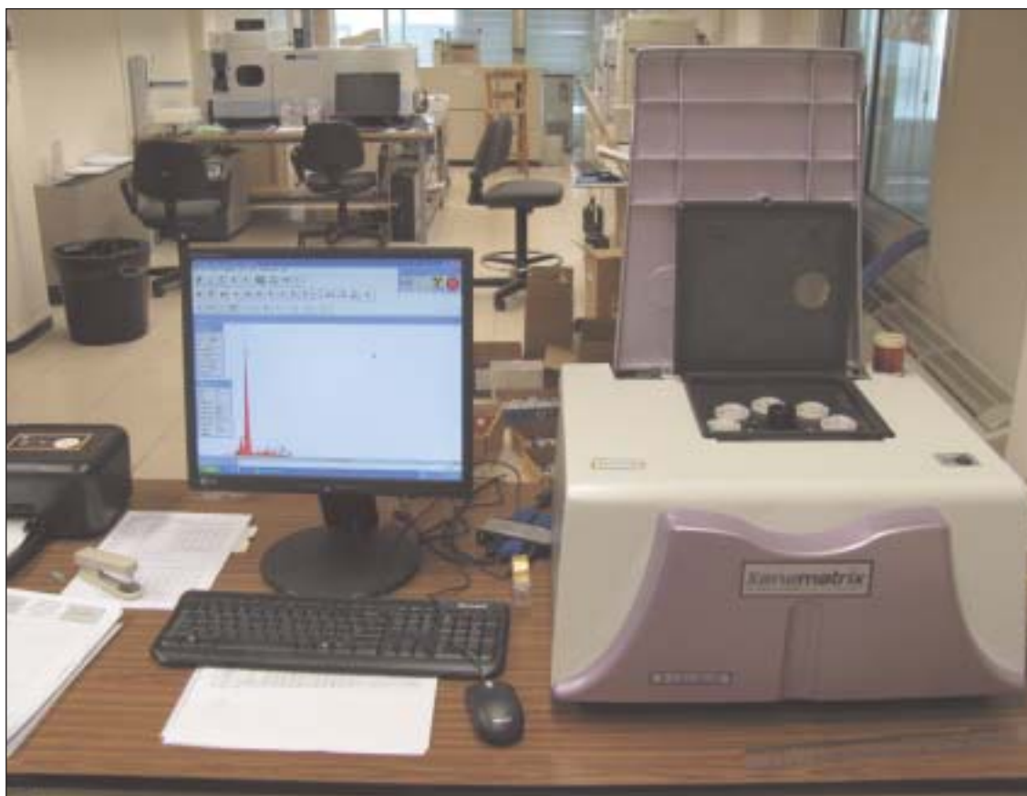
Εικ. 32. Το νέο φασματοσκόπιο φθορισμού με ακτίνες Χ για αναλύσεις στερεών δειγμάτων εδαφών και δομικών υλικών.
