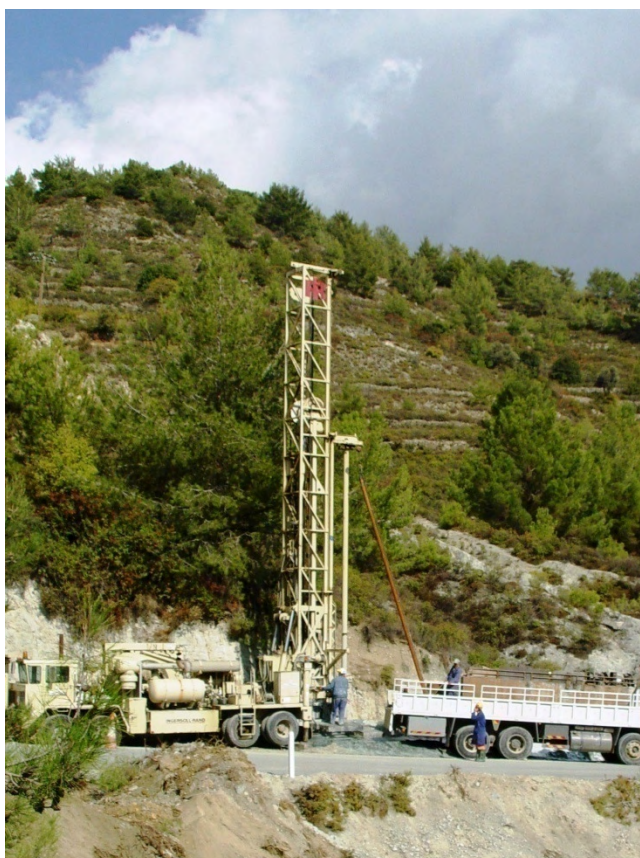
Το σύγχρονο σφυρογεωτρήπανο τύπου Ingersol RD20 (αριστερά) - The contemporary rotary rig, Ingersol RD20 (left)
