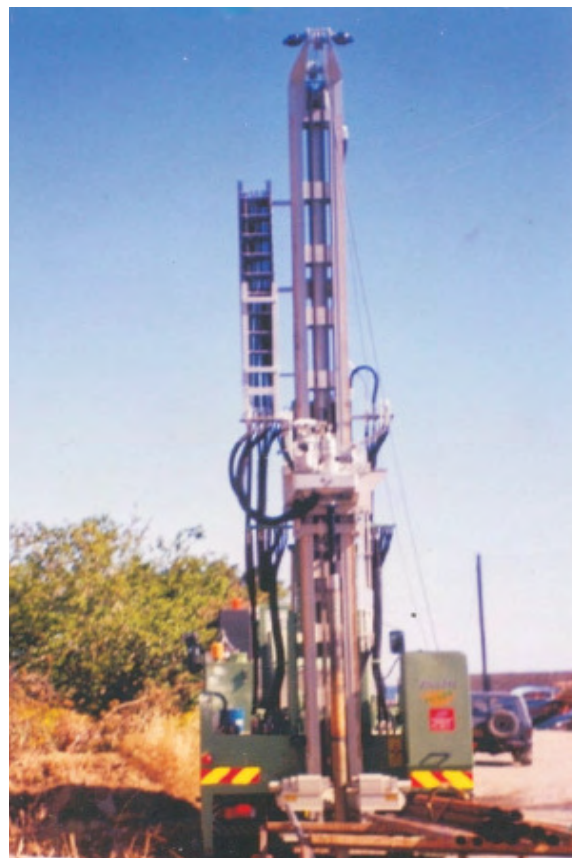
Το σύγχρονο σφυρογεωτρήπανο τύπου Ingersol RD20 (αριστερά) - The contemporary rotary rig, Ingersol RD20 (left)
