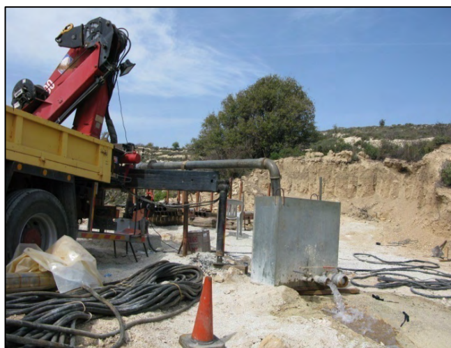
Δοκιμαστική άντληση σε γεώτρηση στην περιοχή Τροόδους Pumping test in a borehole in the Troodos area
