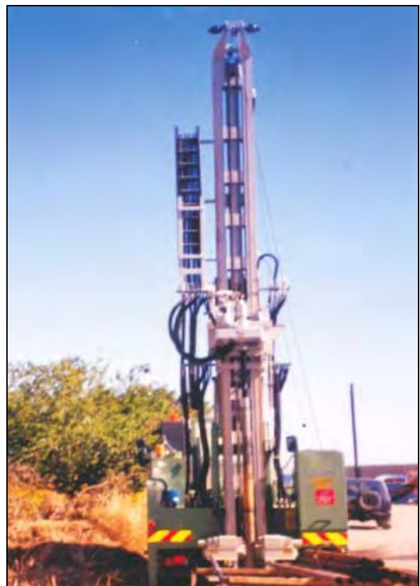
Το δειγματοληπτικό γεωτρήπανο που χρησιμοποιείται στη γεωτεχνική έρευνα Exploratory core drilling rig for geotechnical investigation
