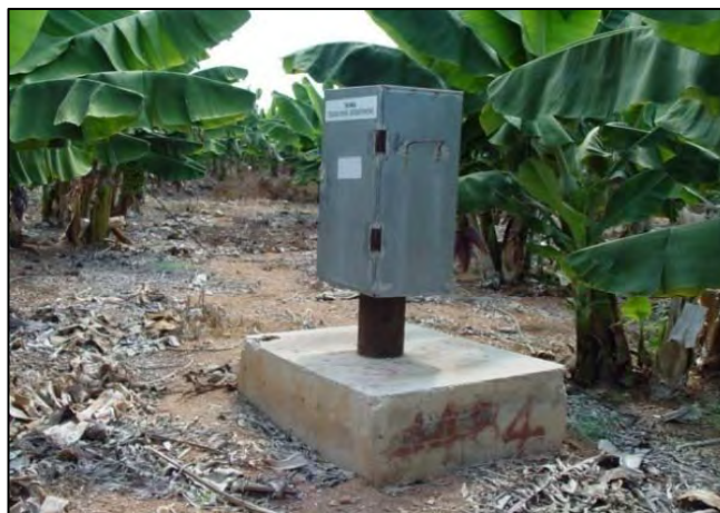
Σταθμός αυτόματης καταγραφής στάθμης, θερμοκρασίας και ηλεκτρικής αγωγιμότητας των υπόγειων νερών Automated monitoring station for groundwater level, temperature and conductivity
