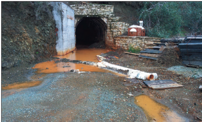
Εικ. 7: Μελέτη περιβαλλοντικών προβλημάτων – Όξινες εκροές από τη στοά του μεταλλείου της Καλαβασού. Fig. 7: Studying environmental problems – acid mine drainage from the Kalavasos mine shaft.
