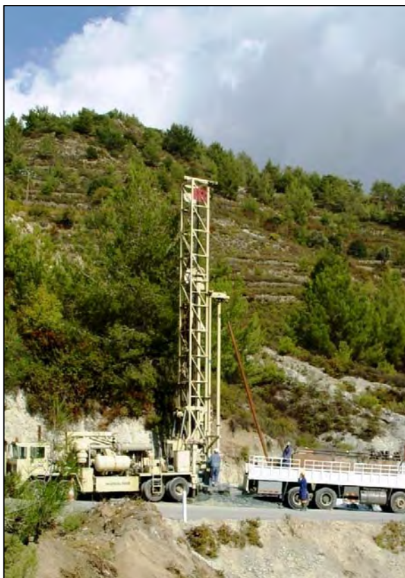
Το σύγχρονο σφυρογεωτρήπανο The contemporary rotary rig
