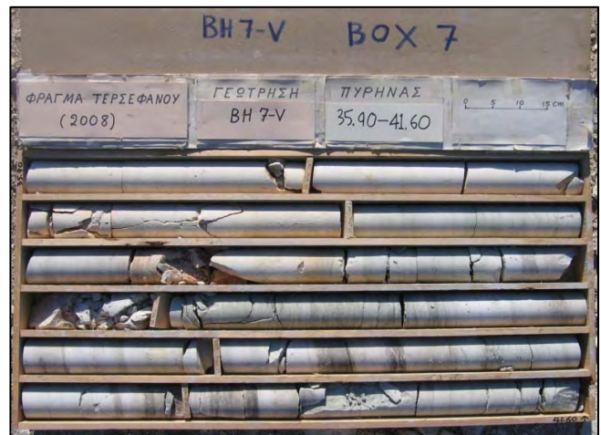
Πορήνας γεώτρησης Γ7 σε Θέση υπερχειλιστή Φράγματος Τερσεφάνου. Διακρίνονται εναλλαγές Κρητίδων – Ινολιθών.
